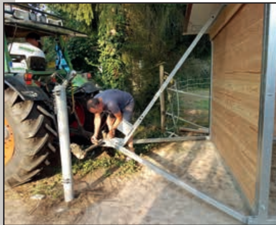
Pour éviter de blesser les chevaux, le timon peut être relevé après le transport
