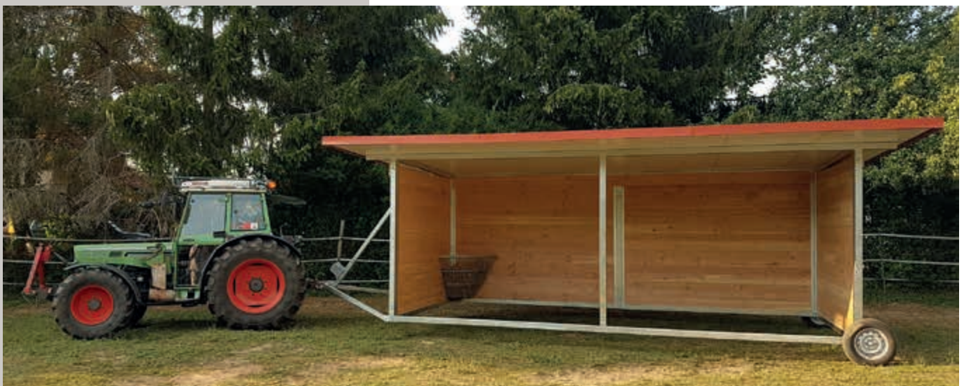
Um Verletzungen der Pferde zu vermeiden, kann die Deichsel nach dem Transport hochgeklappt werden
