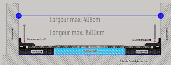
Profil d'assemblage en caoutchouc pour raccorder la surface plane. GR420354
