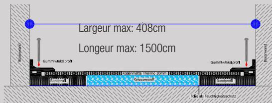
Profil d'assemblage en caoutchouc pour raccorder la surface plane. 45.420354
