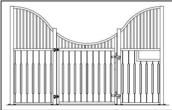
Les façades „Nordsee“ sont ondulées. La hauteur au bord se monte à 2,30 m, au milieu à 1,50 m (hauteur du bois 1,30 m).
